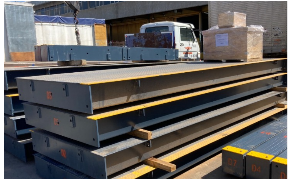
Fotografía 1 Suministro de Estructuras para sistema pesaje de camiones a instalar
